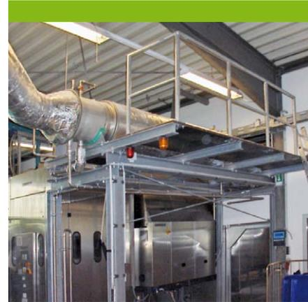
Integration des Wärmetauschers in den Waschprozess
