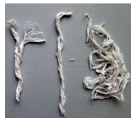
Feuchttücher führen zu Verstopfungen, die in Kläranlagen zunehmend Probleme verursachen.
